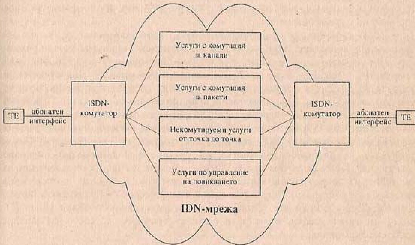
Фиг. 6.22. Конфигурация на ISDN-мрежа
