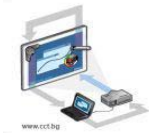
фиг. 1 Схема за работа с интерактивна бяла дъска
